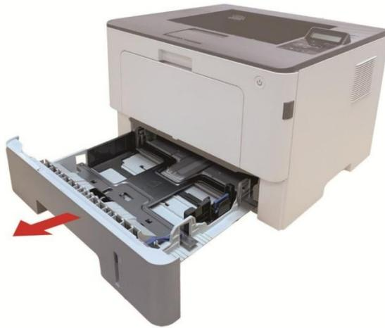
2. 滑動自動進紙盒延長託盤卡扣、長度導紙板及寬度導紙板到所需的紙張尺寸卡槽，匹配紙張的長度和寬度。
