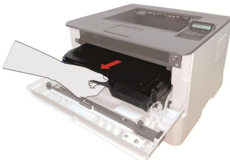
**注：**• 取下雷射碳粉盒時，請將雷射碳粉盒裝入保護袋或用厚紙包裹，避免光線照射而損壞感光鼓。
