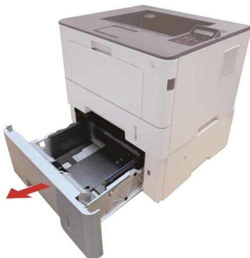
2. 滑動紙盒的長度導紙板、寬度導紙板到所需的紙張尺寸卡槽，匹配紙張的長度和寬度。
